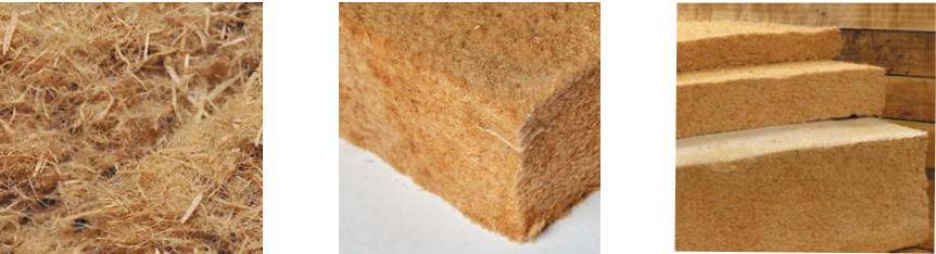
Fig. 57. Transformation de la fibre de bois en panneaux d'isolation
