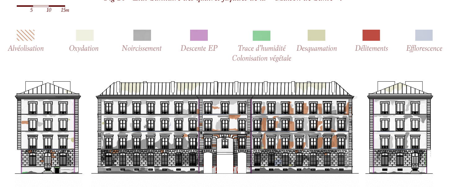
Fig 14 - État Sanitaire des quatres façades de la « Maison de Santé ».
